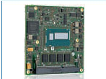
■ Kontron sort le COMe-cSE6 qui est un ordinateur sur module ne requérant aucune maintenance. Il est ainsi conçu pour des applications telles que les interfaces homme-machine (IHM).
