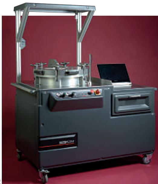
L'Easypem développé par le Pôle de plasturgie de l'est (PPE) est le premier banc disponible sur le marché pour la mesure 3D de perméabilité des renforts secs.
