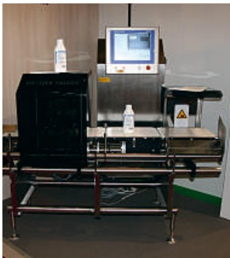
Le système combiné Garvens C3770 présenté par Mettler-Toledo assure un encombrement réduit et une interface utilisateur unique pour le tri pondéral et l'inspection optique.
