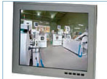
■ Avec de nombreuses configurations de montage disponibles, le Panel PC AHP-2173, qu'a introduit Aaeon, s'intègre en souplesse dans des systèmes de surveillance ou des IHM pour des applications en environnements sévères, telles que des chaînes de production ou des installations industrielles en extérieur.
