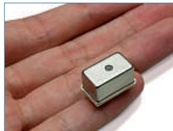
■ Hamamatsu Photonics a présenté sa dernière génération de microspectromètres, avec le modèle C12666MA, pour l'intégration dans des appareils de mesure portables (détection de couleur dans les machines d'impression, contrôle pour éclairage par Led, tests de POC [Point-Of-Care], etc.).
