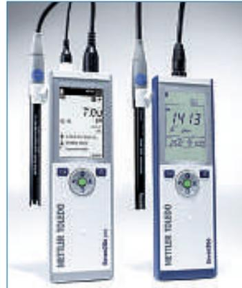
■ Les Seven2Go et Seven2Go Pro, qu'a développés Mettler-Toledo, sont des appareils de mesures physico-chimiques compacts pour le pH/redox, la conductivité ou l'oxygène dissous. Robustes (IP67), légers (222x70x35 mm pour 270 ou 290 g) et ergonomiques, ils assurent une prise en main facile lors d'applications mobiles en laboratoire, en production et en extérieur.
