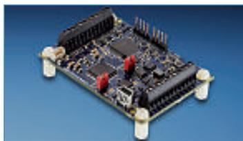
■ Faulhaber propose sa série d'électroniques de commande MCST 3601 pour moteurs pas à pas. Elle permet une régulation précise et une programmation flexible, et convient aux moteurs miniatures, aux courants de phase de 10 mA à 1,1 A.
