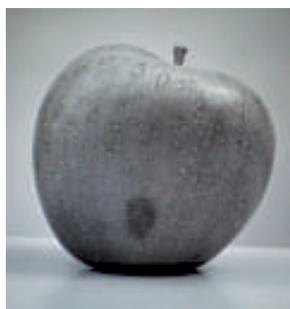
L'infrarouge permet de distinguer facilement la présence d'eau, ou les variations de sa concentration. De nombreuses applications sont possibles dans l'industrie agroalimentaire, comme la détection du degré de mûrissement des fruits, ou la présence de coups invisibles à l'œil nu.
